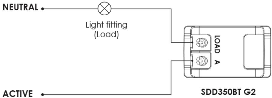
**SDD350BT G2 - Optional wiring diagram**
